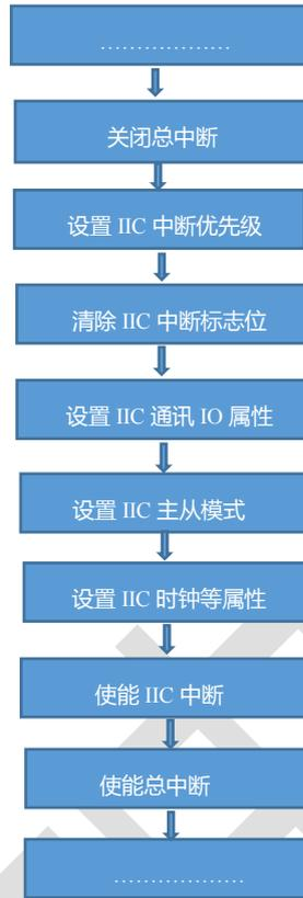
IIC 配置流程示意图
