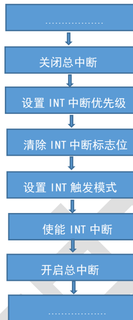
外部中断配置流程
