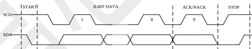
图 10-15 I2C 协议示意图
